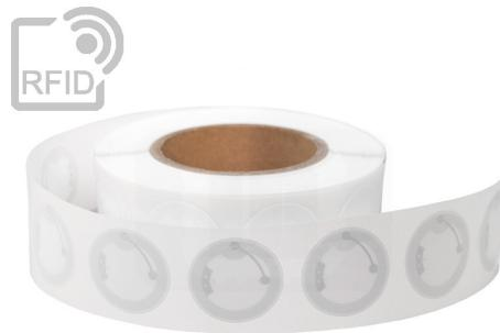
**DESCRIZIONE:** Etichette sticker tag RFID circolari adesive diametro 38 mm in carta / PET plastificate personalizzabili con pre-stampa a colori, numerazioni e codici a barre QR Code ICode SLIX iso 15693 chip RFID lettura e scrittura (Read/Write) HF 13,56 MHz ISO 15693 ISO 18000.
