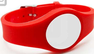
**DESCRIZIONE:** Braccialetto RFID con quadrante circolare con corpo in pvc e diametro regolabile con chiusura in fibbia metallica Mifare Classic ® 1K Ev1 chip S50 RFID lettura e scrittura (Read/Write) HF 13,56 MHz ISO 14443A.
